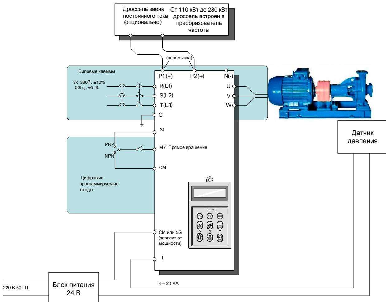
Отнеситесь внимательно к клемме заземления! - Это клемма G!
