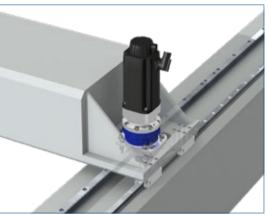
Линейная система Premium с  $\mathbf{RP^+}$  и соответствующими угловыми версиями / актуаторами применяется в основном в металлообрабатывающих станках в конфигурации «ведущий-ведомый» с электронным преднатягом. Это позволяет достигать силы подачи до 113 000 Н/привод.
