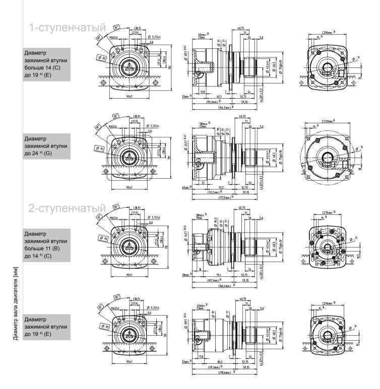
Размеры без установленных допусков — номинальные размеры Подробная информация о размерах зубчатых реек — стр. 151 и далее
