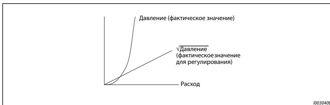
**Рис. 5-167:**  $\text{Расход} \propto \sqrt{\text{давление}}$
