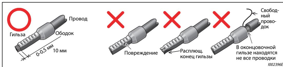
Рис. 2-32: Опрессовка оконцевочной гильзы
