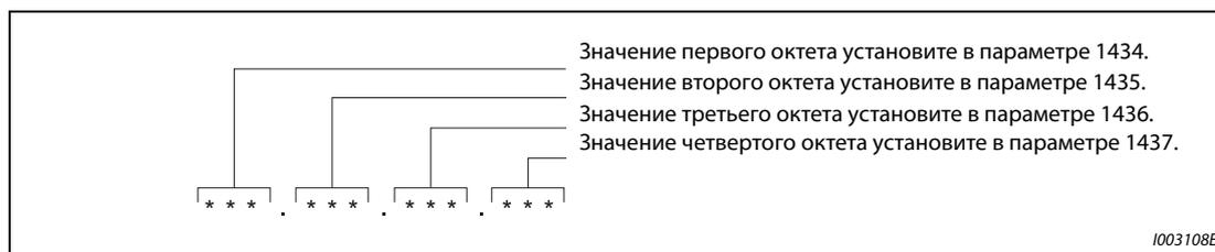
**Рис. 5-248:** Настройка IP-адреса
