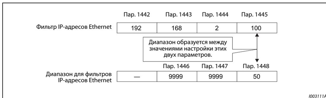
**Рис. 5-252:** Пример 2 настройки для фильтрации IP-адресов Ethernet
