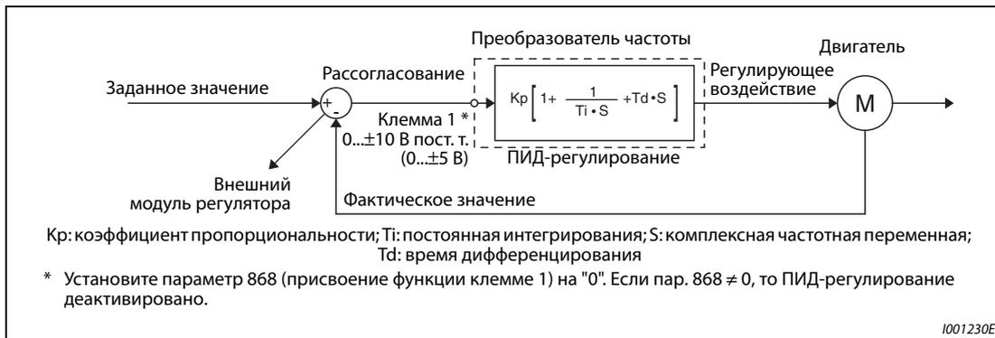
**Рис. 5-159:** Конфигурация системы для пар. 128 = 10, 11 (использование внешнего компаратора)
