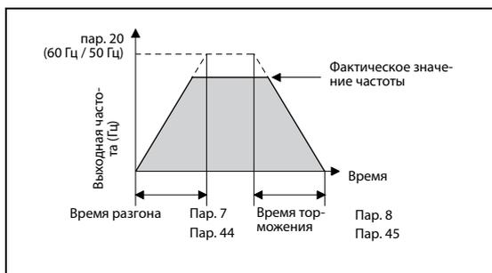
**Рис. 5-17:** Время разгона/торможения
